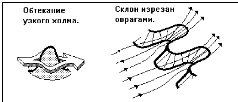
Рис. 117. Обтекание узкого холма и склона изрезанного оврагами.
