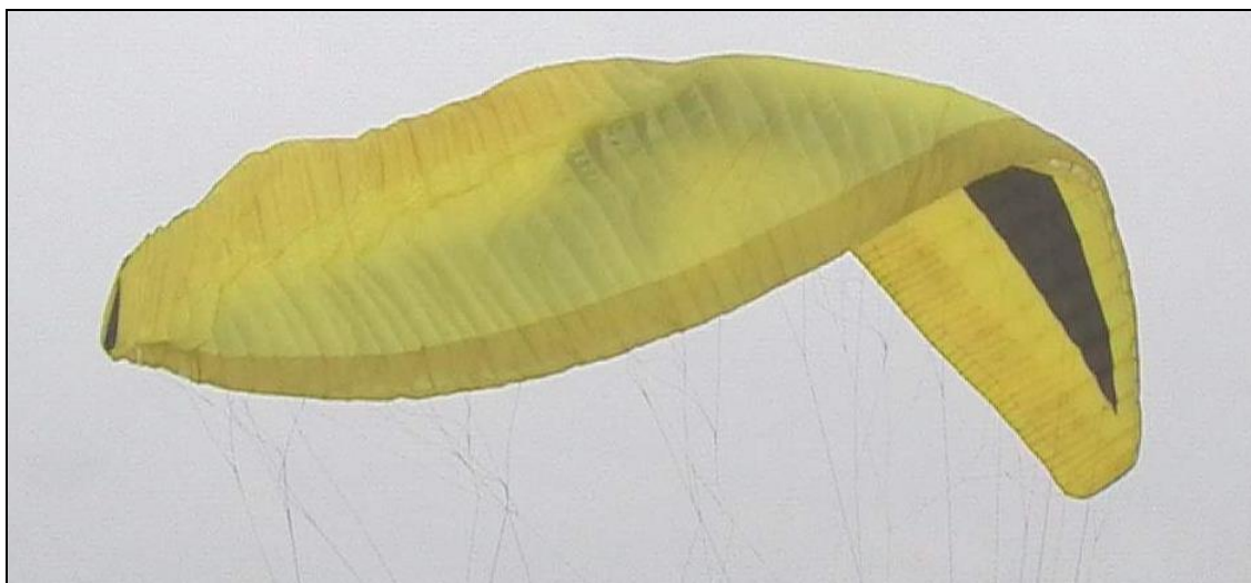
Рис. 65. Начало сложения крыла парашюта по передней кромке.
