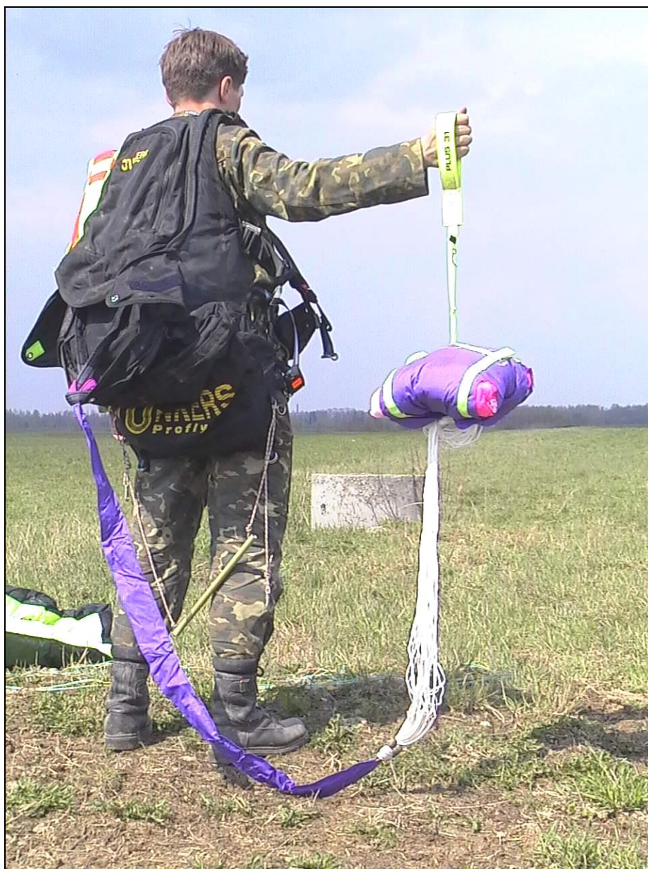
Рис. 98. Потянув за вытяжную ручку, пилот достает из парашютного контейнера камеру с куполом и стропами.
