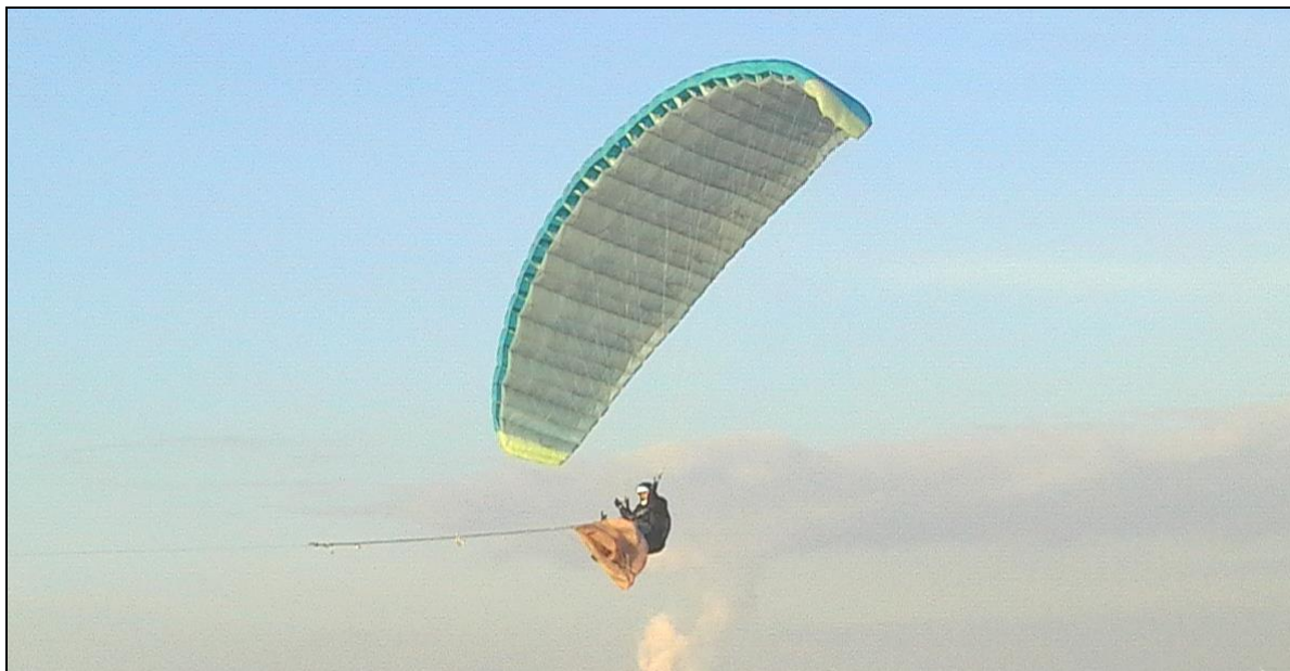
Рис. 70. Буксировка Хантера. Параплан производится в Подмосковном городе Жуковский фирмой АСА. Аппарат предназначен для первоначального обучения и полетов с парамотором. Класс «standard».
