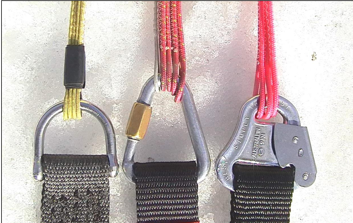
Рис. 56. Примеры карабинов-коннекторов строп.
