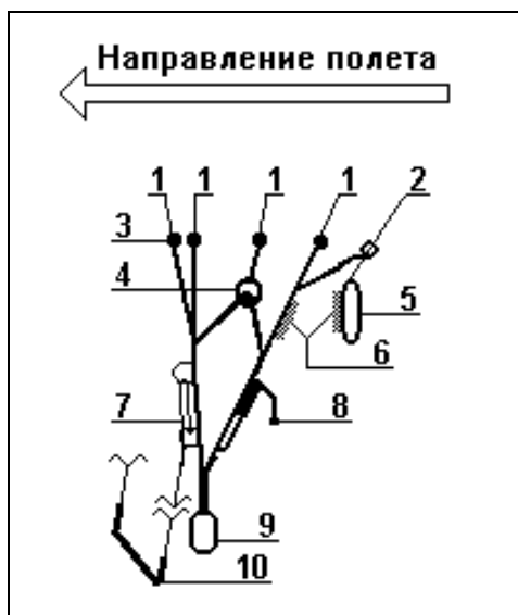
Рис. 55. Пример конструкции свободных концов.
