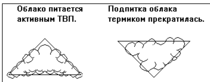
Рис. 132. Определение термиков по кучевым облакам.
